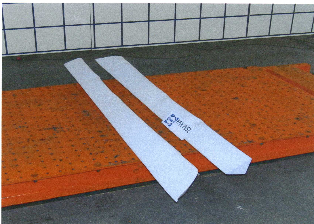
Fot. 2. Owiewki boczne lewa i prawa po testach dynamicznych w kierunku wzdłużnym i poprzecznym
