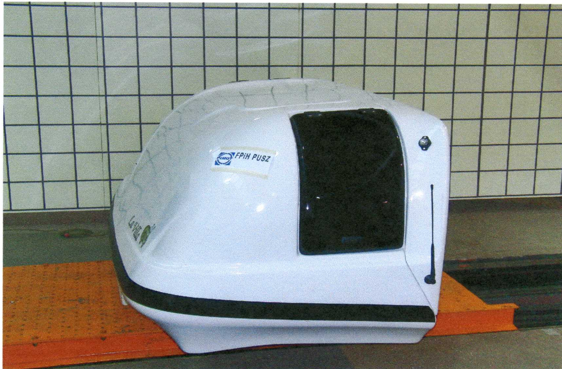
Fot. 1. Nadbudowa sypialna „LA VILLA” po testach dynamicznych w kierunku wzdłużnym i poprzecznym
